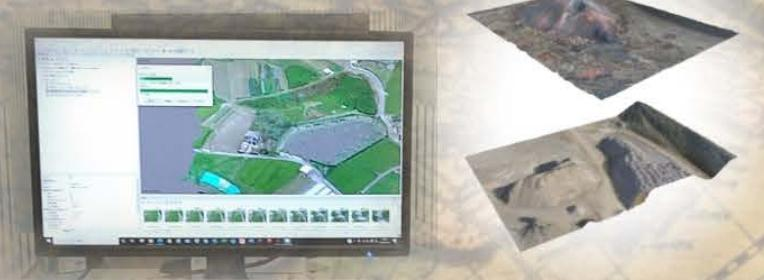
専用ソフトを使用し、上記レーザースキャナやドローン(UAV)写真測量などで取得した点群データを基に立体的に表示することができ、高度な三次元での設計ができます。
